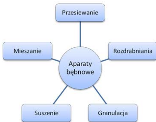
Rys. 1. Zastosowanie aparatów bębnowych w procesach przemysłowych.
