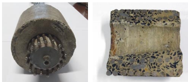
Rys. 2. Widok i przekrój zakotwienia z betonu (żelbetu)
