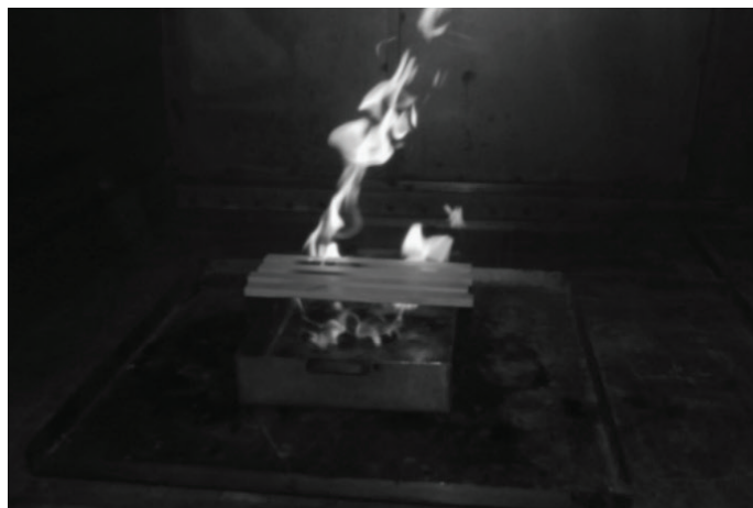
Rys. 3. Ułożenie próbek drewna w komorze przy spalaniu płomieniowym.
