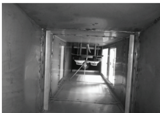
Rys. 3. Ułożenie próbek drewna w komorze przy spalaniu płomieniowym.
