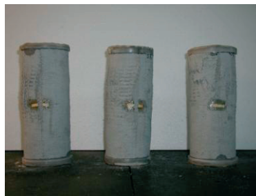
Rys. 7. Obraz zniszczenia elementów typu z/u=0,4
