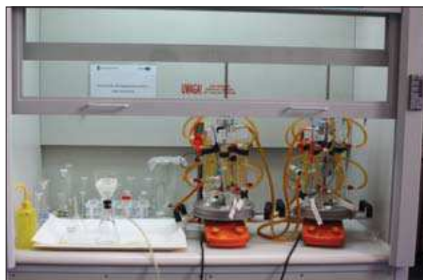
Fot. 2. Stanowisko do ługowania rudy uranowej
