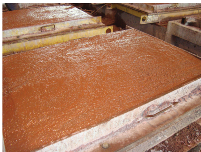
Fot. 5 i 6. Forma stalowa przygotowana do wykonania betonowej płyty peronowej – widoczna charakterystyczna faktura wierzchniej powierzchni płyty (negatyw) oraz podwójna siatka zbrojeniowa z prętów żebrowanych i po wypełnieniu betonem
