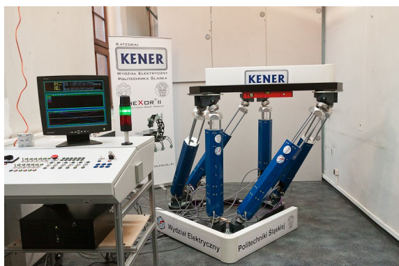
Rys. 1. Manipulator równoległy jako stanowisko laboratoryjne
