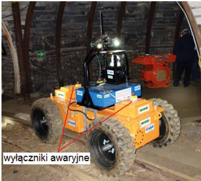
Rys. 1. Rozmieszczenie wyłączników awaryjnych S1 i S2 na Mobilnej Platformie Inspekcyjnej
