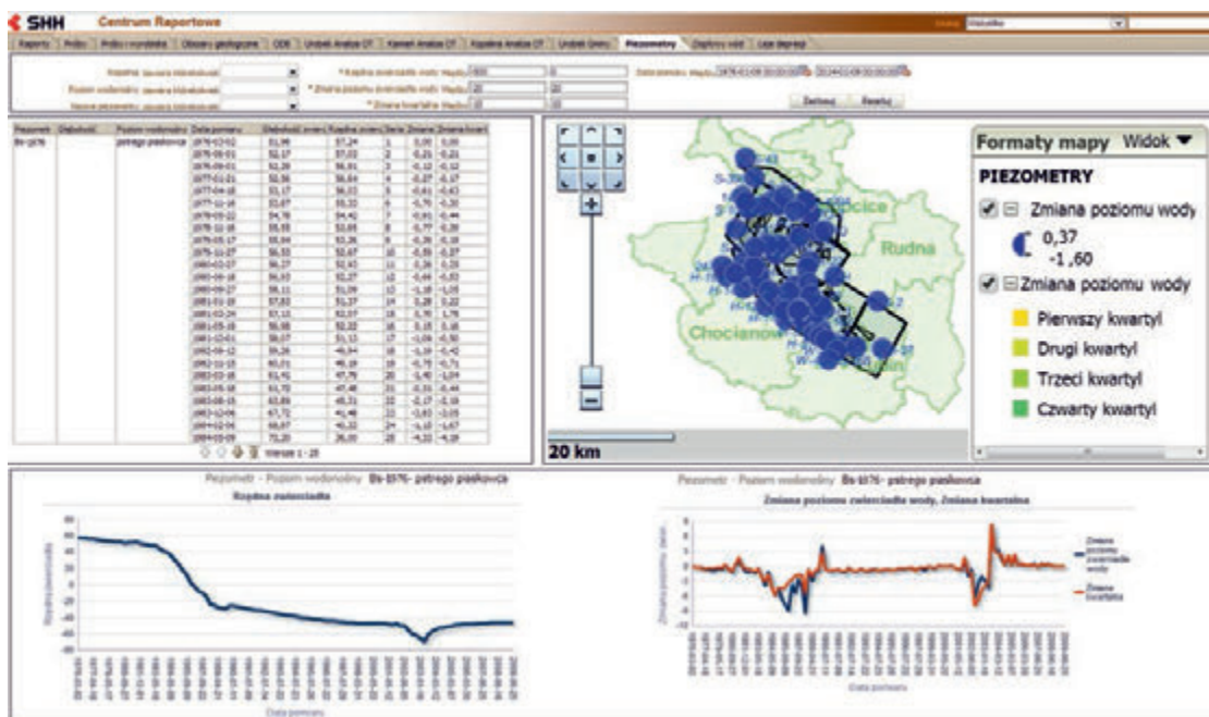
Rys. 6. Zestawienie danych hydrogeologicznych, obrazujących pomiary zwierciadła wody. Część tabelaryczna przedstawia wyniki pomiarów piezometrycznych w wybranym piezometrze. Wykresy prezentują zmianę zwierciadła wody w czasie. Fragment mapowy kokpitu prezentuje wielkość zmiany poziomu zwierciadła wody we wszystkich piezometrach obserwujących wybrany poziom wodonośny
