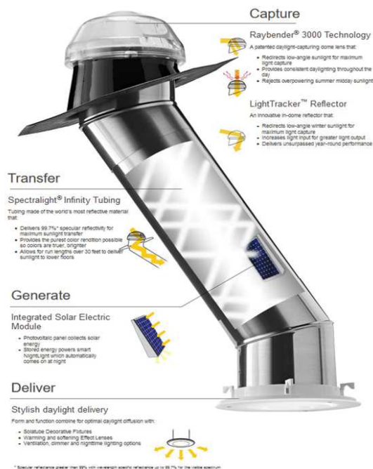
Fig. 4. Principle of operation of the light-emitting tube [11] Rys. 4. Zasada działania rurki emitującej światło [11]
