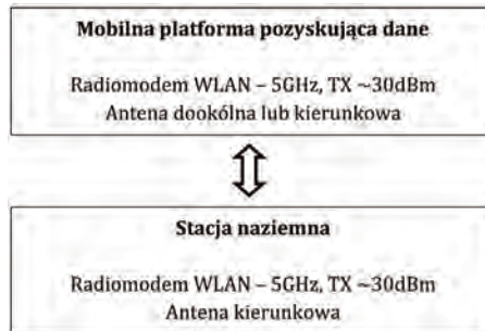
Rys. 5. Ogólna koncepcja systemu łączności radiowej, źródło: opracowanie własne
