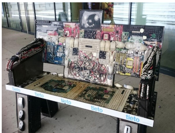
Rys. 9.8 Mebel miejski z odpadów elektronicznych (komputerowych) zatopionych w żywicy epoksydowej – Dolní Oblast Ostrava-Vítkovice
