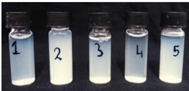
Rys. 6. Zdjęcie badanych zawieszin \text{TiO}_2 po czasie 17 godzin (1 – niemodyfikowany \text{TiO}_2 , 2 – \text{TiO}_2 modyfikowany kw. pelargonowym, 3 – \text{TiO}_2 modyfikowany kw. laurynowym, 4 – \text{TiO}_2 modyfikowany kw. oleinowym i 5 – \text{TiO}_2 modyfikowany dodecyloaminą)
