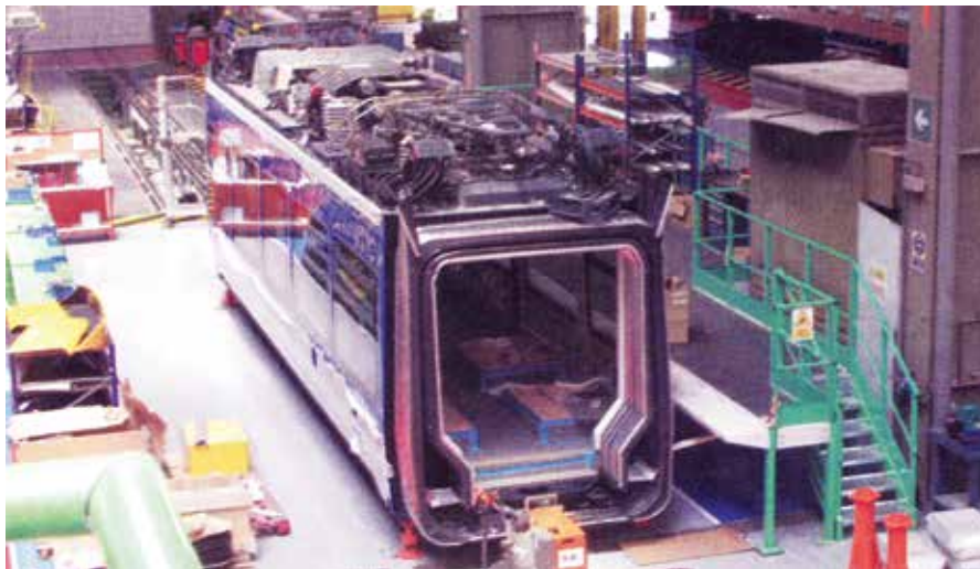
Środkowy człon dwusystemowego pojazdu dla Sheffield ma transformator ABB-Sécheron i falownik zasilający jeden wózek, jak również klimatyzator i pantograf. Fot. H. Hondius
