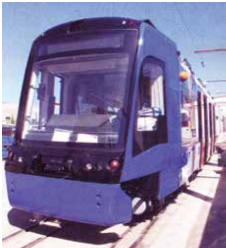
Pierwszy pojazd dwusystemowy dla Sheffield gotowy do badań. Prosty sprzęg Alberta osłania ruchomy panel przedni. Fot. H. Hondius
