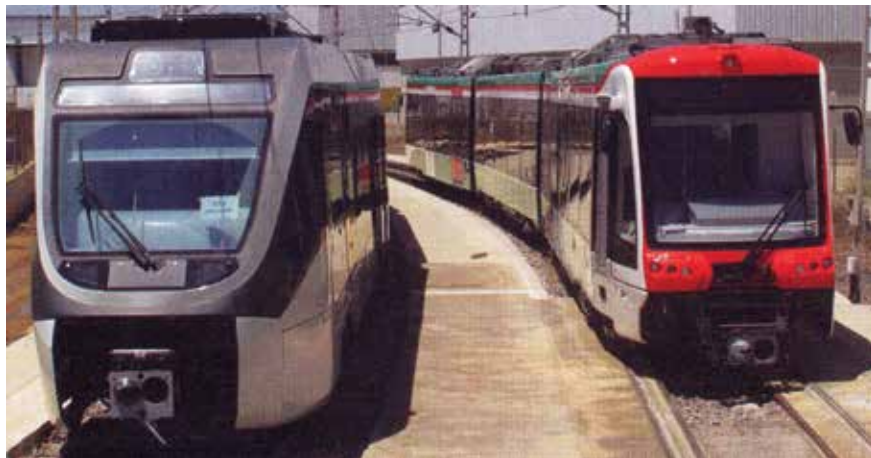
Pojazdy dwusystemowe dla FEVE (Hiszpania) i Chemnitz (CVAG) na torze testowym firmy Vossloh España: oba wyposażone w agregaty power pack (PP) firmy MTU. Czerwone drzwi są przeznaczone dla przystanków o wys. 550 mm, a białe dla przystanków o wys. 380 mm. Fot. H. Hondius
