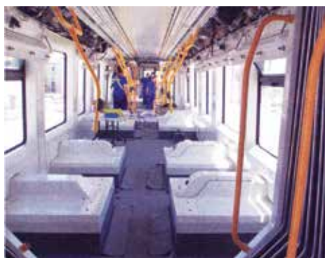
Pojazdy dla Sheffield mają jednostopniowe podwyższenie w członie środkowym w stosunku do niskopodłogowych wejść w członach skrajnych. Fot. H. Hondius
