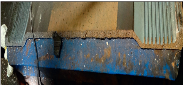
Rys. 7. Oddzielone łapy od pozostałej części korpusu silnika
