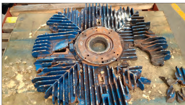
Rys. 2. Fragmenty tarczy łożyskowej od strony napędowej
