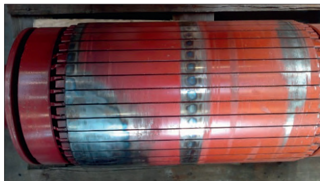
Rys. 4. Wirnik uszkodzonego silnika
