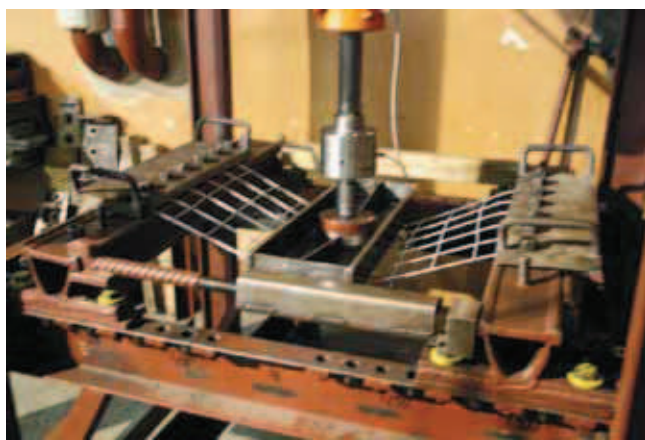
Rys. 3. Stanowisko badawcze i siatka po badaniu wytrzymałości Fig. 3. Test stand and the lagging sheet after the endurance test
