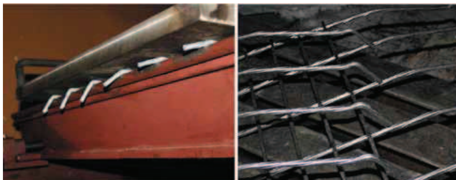
Rys. 6. Wyprostowane zaczepy siatki po badaniu Fig. 6. Straightened lagging sheets after the test
