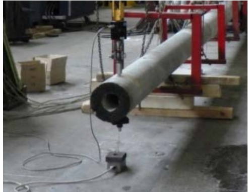
Fot. 5. Czujnik przemieszczeń w miejscu przyłożenia siły Photo 5. Displacement sensor at the point of force application
