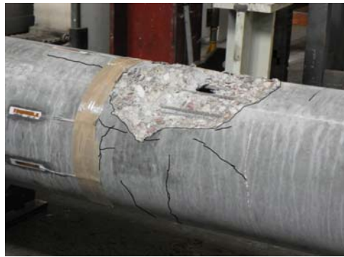
Fot. 11. Zniszczenie żerdzi w strefie przy podporowej Photo 11. Destruction of the pole in support area
