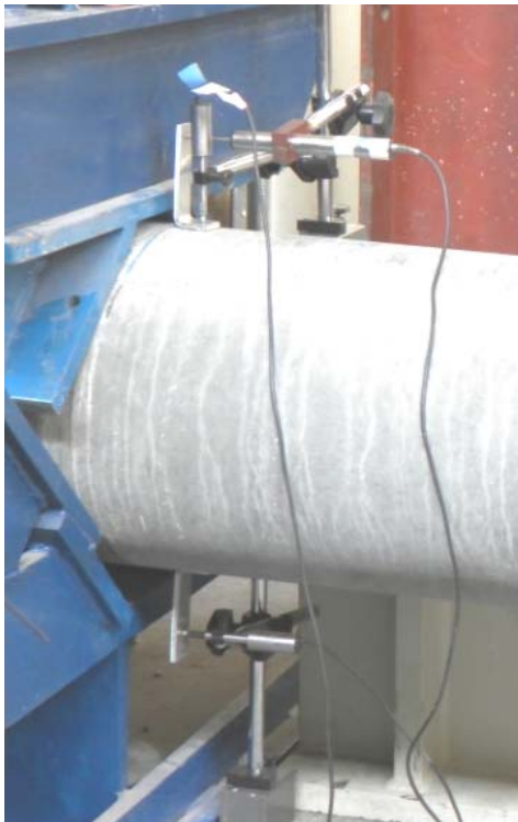
Fot. 4. Czujniki przemieszczeń w przekroju przy podporze Photo 4. Displacement sensors in support section
