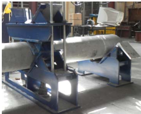
Fot. 2. Widok podpory części odziomkowej Photo 2. View of part of pole support
