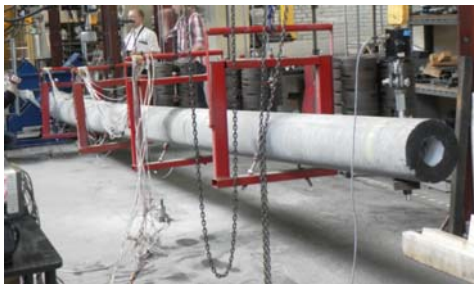
Fot. 12. Widok żerdzi po zniszczeniu (siła 15,6 kN) Photo 12. View of the pole after destruction (Force 15,6 kN)
