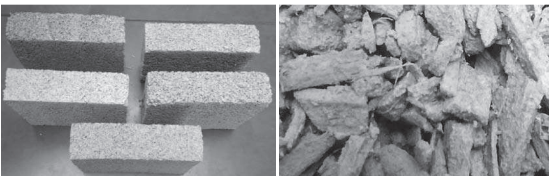
Rys. 3. Próbkę kompozytu konopno-wapiennego (zdjęcie własne autora)
