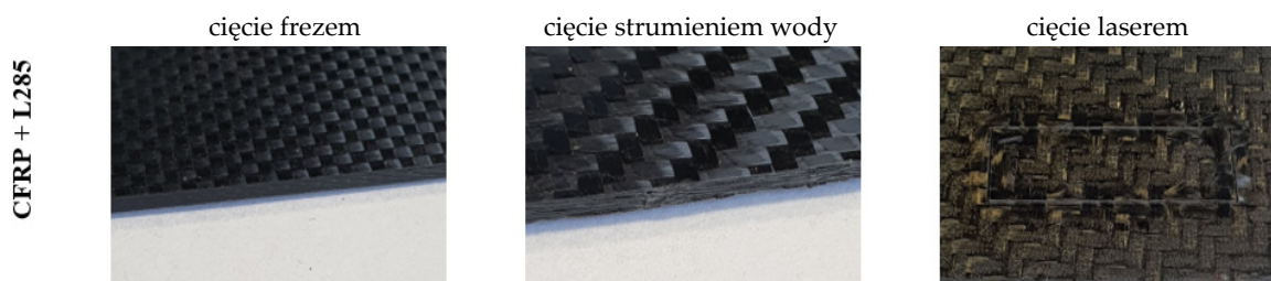
Rys. 2. Matryca wyników badań do cięcia płyt kompozytowych za pomocą następujących metod obróbki: frezowania, ściernego cięcia strumieniem wody, cięcia wiązką laserową; w skali makro [opracowanie własne]
