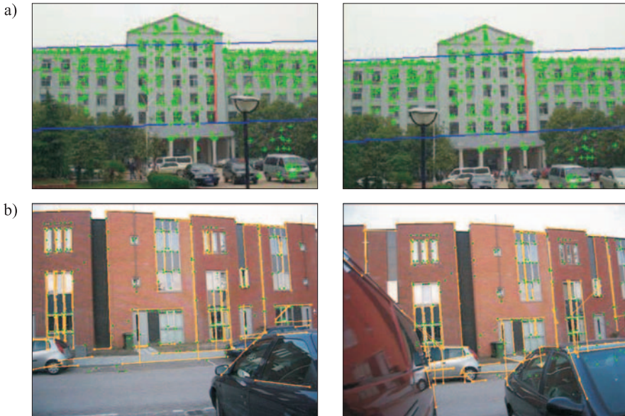
Rys. 2. Identyfikacja punktów i elementów charakterystycznych na dwóch kadrach filmu: a) Ding, Zhang, 2008; b) Tian et al. , 2008.
