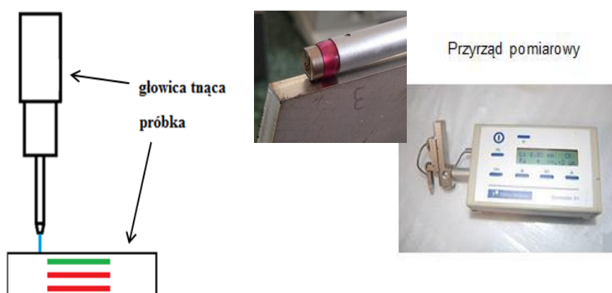
Rys. 15. Istota pomiaru profilu wysokości chropowatości R_z Fig. 15. The essence of measuring of the roughness profile R_z
