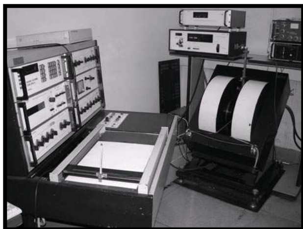
RYS. 1. Spektrometr elektronowego rezonansu paramagnetycznego (EPR) na pasmo X. FIG. 1. An X-band electron paramagnetic resonance spectrometer.
