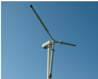
Rys. 2.5. Wirnik wykorzystujący efekt Magnusa [15].
