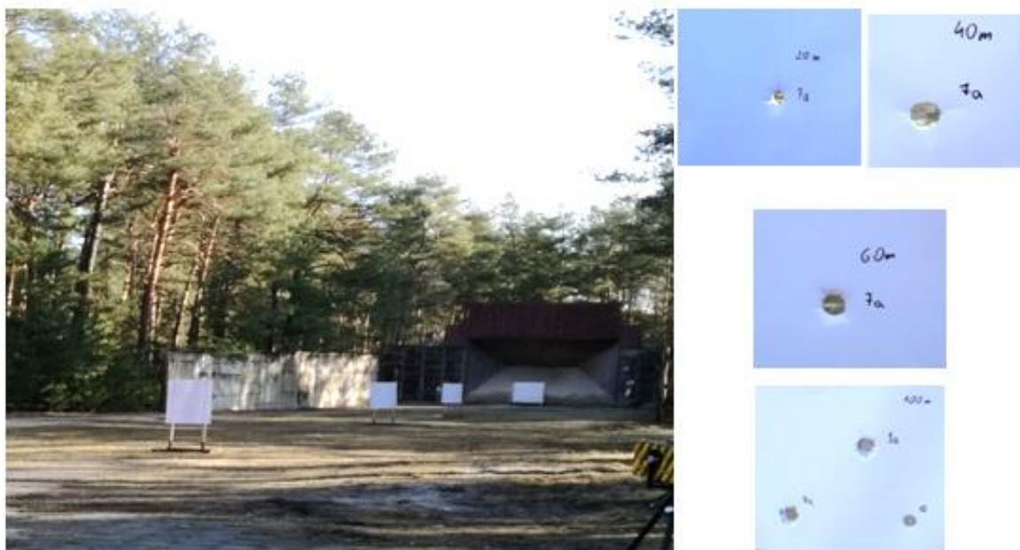
Fot. 2. Tor strzelecki: zestaw tarcz do badania stabilizacji pocisku oraz widoki tarcz z przestrzelinami umieszczonych odległościach 20 m, 40 m, 60 m i 100 m od wylotu lufy
