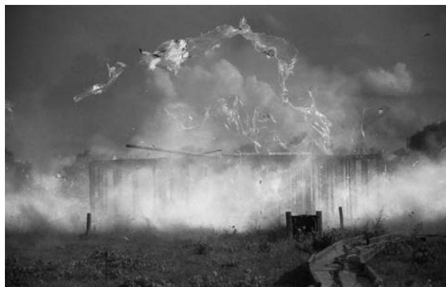
Fig. 2. Vapour explosion in a confined space – VCE [11] Ryc. 2. Wybuch par w przestrzeni ograniczonej – VCE [11]
