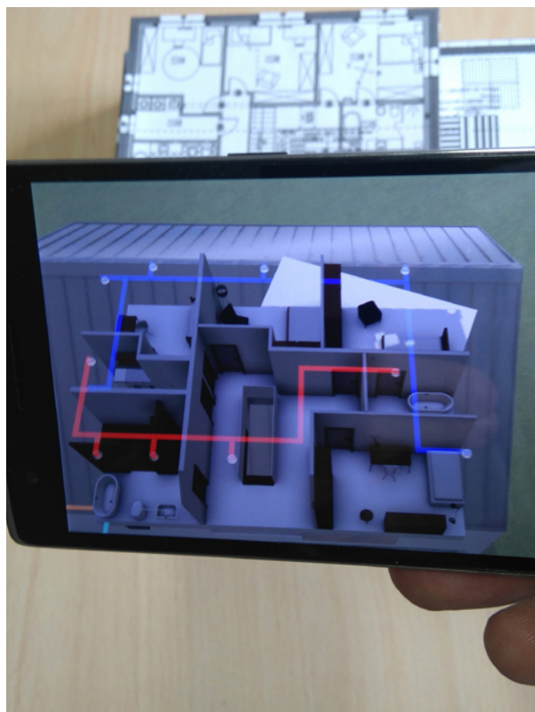
Ryc. 6. Po zdjęciu dachu makiety wyświetla się widok kondygnacji ze schematem wentylacji z rekuperacją. Przykład fizycznej interakcji z obiektem; źródło: fot. autor
