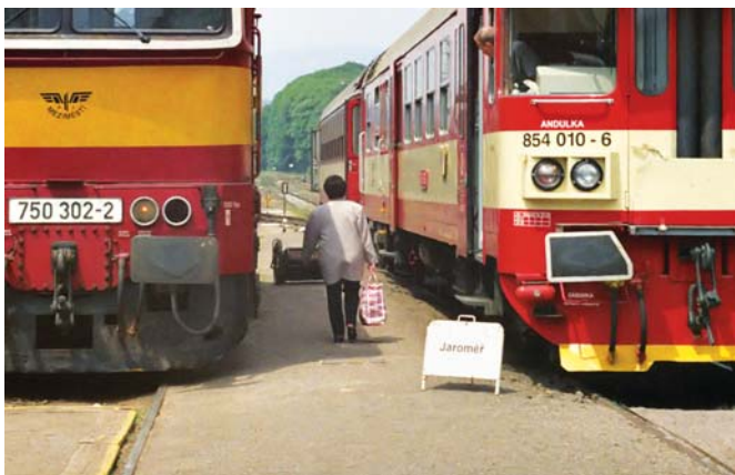
Fot. 15. Przenośna tablica kierunkowa ustawiona na peronie (Trutnov). Fot. W. Gąsior
