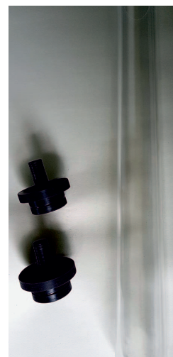
Fot. 3. Widok rury z tworzywa wraz uszczelnieniami, w których umocowano dopływ i odpływ cieczy wiertniczej
