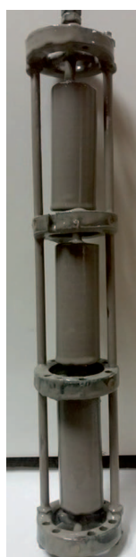
Fot. 4. Rdzenie z osadem płuczkowym (po przemyciu płuczką)
