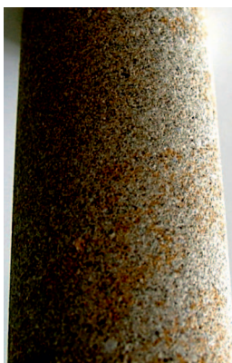
Fot. 2. Rdzeń wycięty z próbki piaskowca
