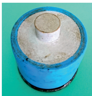
Fot. 12. Próbkę przygotowaną do badań przyczepności na kontakcie stwardniały zaczyn cementowy – skała
