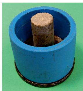
Fot. 11. Próbkę rdzenia przygotowaną do wypełnienia zaczynem cementowym
