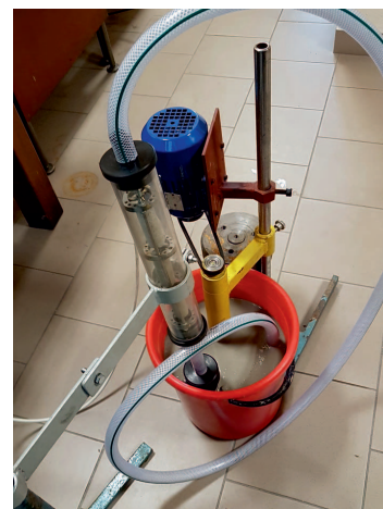
Fot. 1. Otworowy symulator przepływu cieczy wiertniczych (urządzenie w trakcie tłoczenia cieczy)
