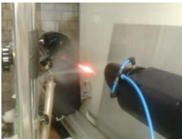
Рис. 2. Процесс регистрации развития топливной струи на лазерной установке Malvern Instruments типа Spraytec
