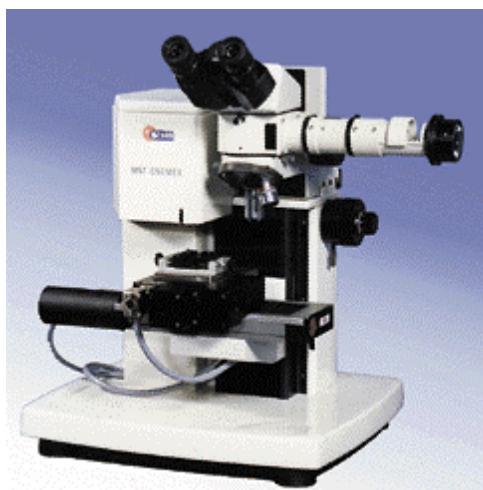
Rys. 2. Urządzenie zastosowane do badania właściwości mechanicznych powłok Nikasil
