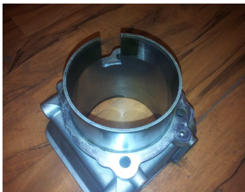
Rys. 1. Cylinder silnika motocyklowego Ducati S2R po wycięciu próbki do badań zużycia powłoki Nikasil
