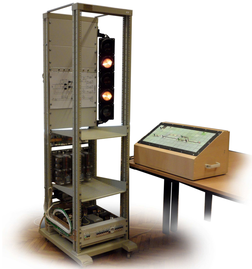
Fot. 2. Widok stanowiska badania obwodów świateł
