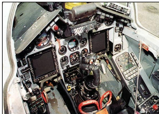
Fot. 6. Widok wnętrza kabiny samolotu wojennego MiG-29 po modernizacji w awionikę cyfrową [materiał ITWL, 2013]
