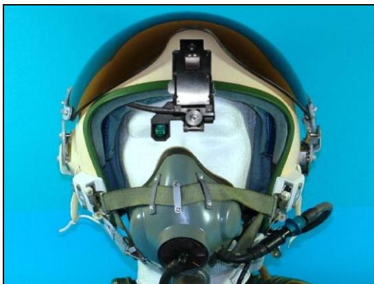
Fot. 7. Widok hełmu dla samolotu MiG-29 z przeziernym wyświetlaczem nahlmowym WDN-1 dla systemu nahlmowego w wersji podstawowej [materiał ITWL, 2015]
