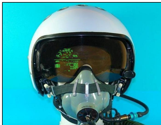
Fot. 8. Widok hełmu dla samolotu MiG-29 ze zobrazowaniem na wizjerze nahlmowego systemu zobrazowania w wersji rozszerzonej [materiał ITWL, 2015]
