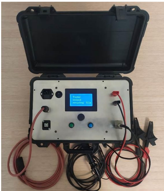
Rys. 1. Prototyp urządzenia diagnostycznego do badania izolacji zwojowej
