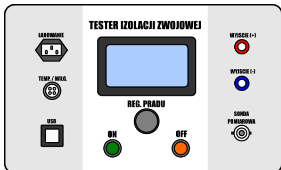
Rys. 2. Panel kontrolny urządzenia diagnostycznego do badania izolacji zwojowej
