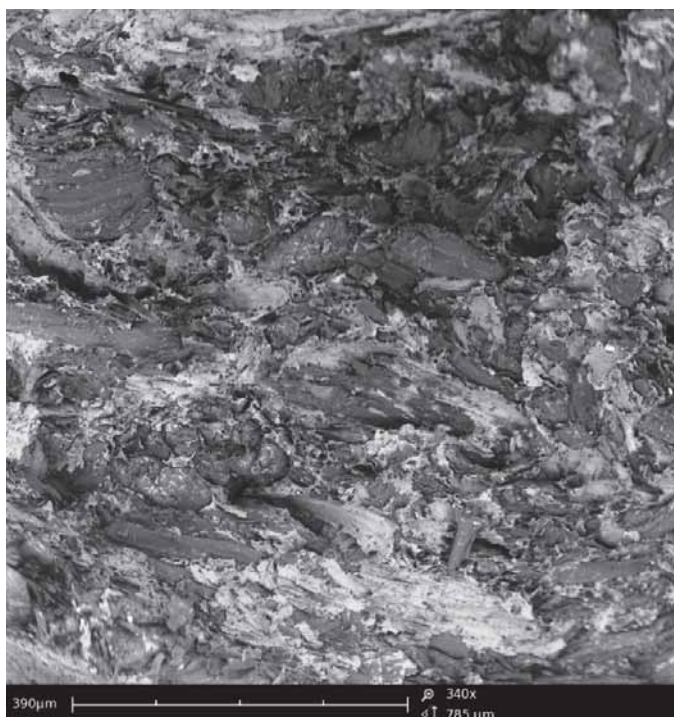
Rys 5. Obraz SEM struktury kompozytu WPC IV wykonany w powiększeniu 340 razy
