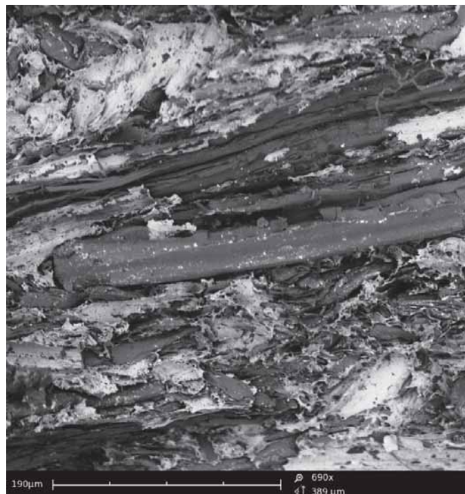
Rys 4. Obraz SEM struktury kompozytu WPC III wykonany w powiększeniu 690 razy
