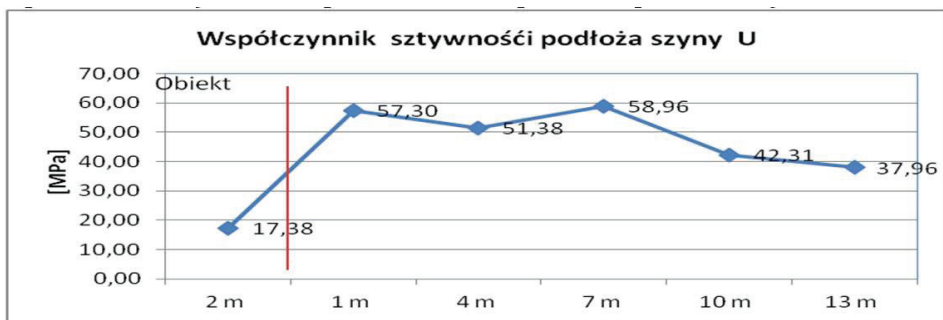
Rys. 4. Obiekt 4: rozkład współczynnika podłoża szyny na długości toru - strona północna, pomiar pod obciążeniem statycznym
