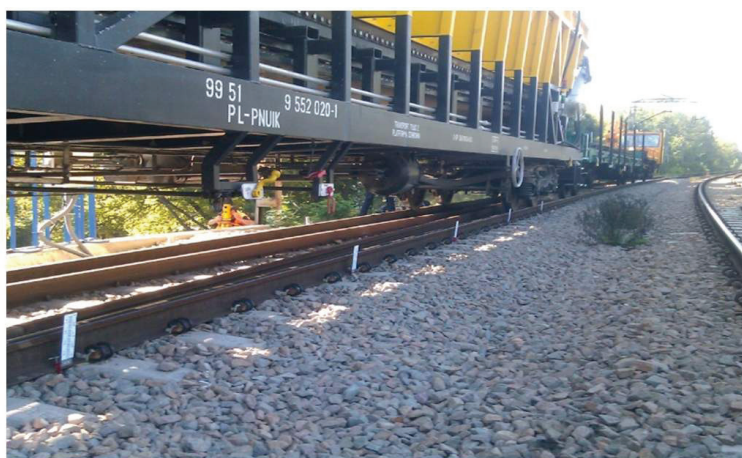
Fot. 3. Rozmieszczenie latek niwelacyjnych w na szynach {10}
