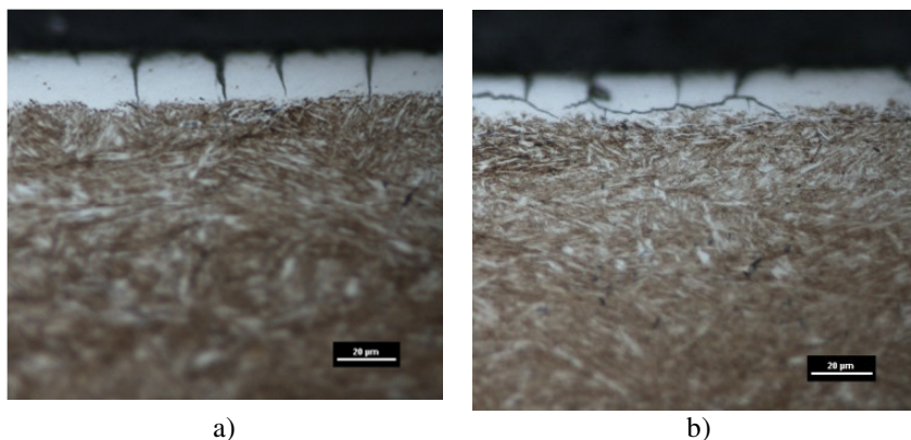
Rys. 3. Pęknięcia promieniowe (a) i obwodowe (b) w obszarze warstwy azotków żelaza
