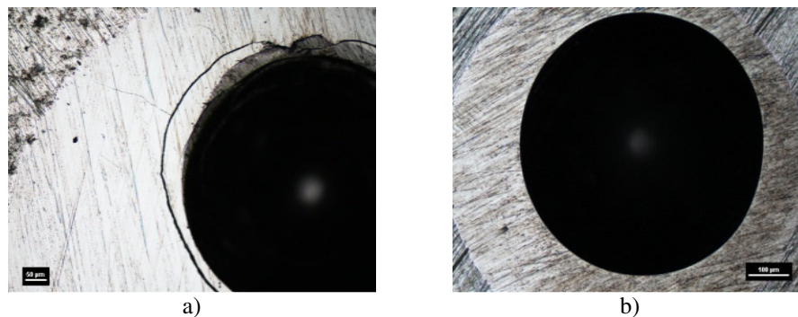
Rys. 6. Struktura powierzchni azotowanej stali 38HMJ w obrębie zglądu sferycznego na krawędzi śladu odcisku twardości Rockwela HRC (metoda Baltest-M): a – warstwa azotowana z warstwą azotków żelaza z widocznymi pęknięciami obwodowymi i promieniowymi (wariant A), b – warstwa azotowana z ograniczoną warstwą azotków żelaza (wariant B)
