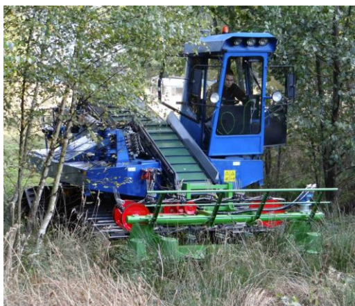
Fig. 1. The tracked vehicle during sedge cutting trials - PIMR-BE archives Rys. 1. Pojazd gąsienicowy podczas prób koszenia turzycy – archiwum PIMR-BE
