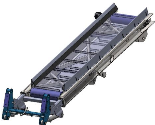
Fig. 5. The virtual model of the new version of the loading transporter unit - PIMR-BE archives Rys. 5. Model wirtualny nowej wersji wysięgnika roboczego – archiwum PIMR-BE
