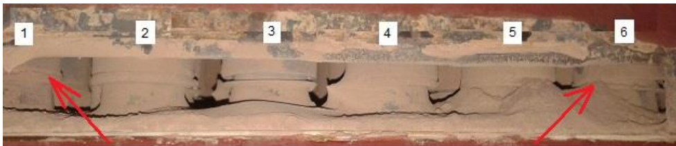
Rys. 19. Widok szczelin wylotowych pyłu z cyklonów po zadozowaniu do filtra 2150 g pyłu i pracy ze stopniem odsysania pyłu m_o = 5\% – widok od strony kolektora odsysającego pył: 1, 2, 3, ... , 6 – numer kolejny cyklonu w kolumnie (strzałką zaznaczono cyklony, w których szczeliny zostały zablokowane pyłem) [8]
