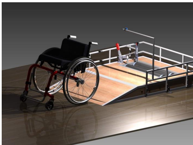
Rys. 4. Ustawienie wózka przed wjazdem na platformę.
