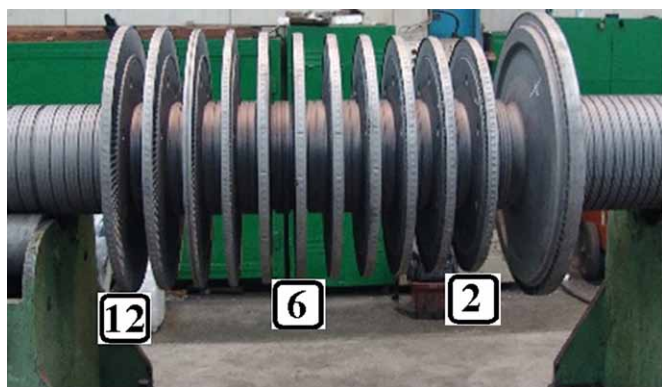
Rys. 1. Wirnik WP – oznaczenie stopni łopatek (Fot. zbiory prywatne autora)
