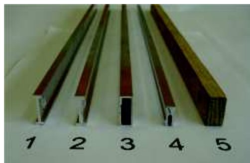
Rys. 3. Przekroje profili w badanych kratkach maskujących: 1 – profil aluminiowy P1 o przekroju dwuteowym, 2 – profil aluminiowy P2 o zwiększonym przekroju dwuteowym, 3 – profil aluminiowy P3 o przekroju rury prostokątnej, 4 – profil aluminiowy P4 o przekroju typu A, 5 – profil drewniany P5 o przekroju prostokątnym
