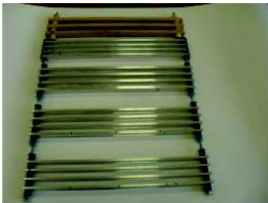
Rys. 6. Zestawy czterech profili przygotowanych do prób zginania
