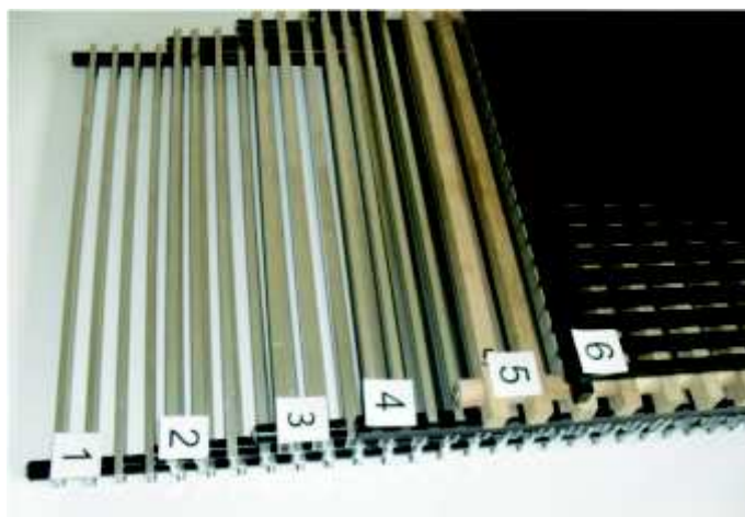
Rys. 2. Kratki maskujące poddane badaniom: 1 – aluminiowa z profilu o przekroju dwuteowym łączona sprężyną, 2 – aluminiowa z profilu o zwiększonym przekroju dwuteowym łączona sprężyną, 3 – aluminiowa z profilu o przekroju prostokątnym łączona sprężyną, 4 – aluminiowa z profilu typu A łączona spinką z tworzywa sztucznego, 5 – drewniana z profilu o przekroju prostokątnym łączona sprężyną, 6 – aluminiowa wzdłużna z profilu o typu A
