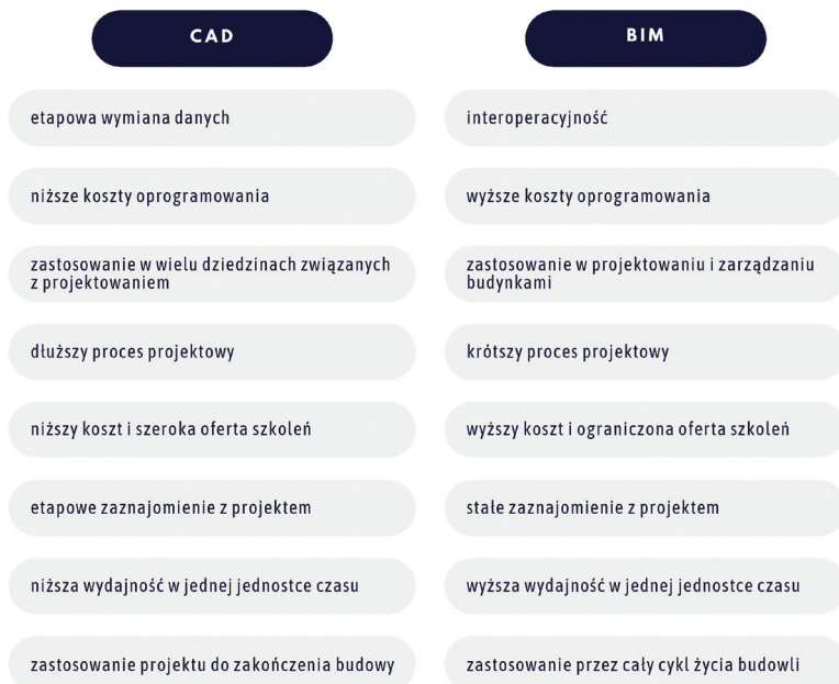
Rys. 5. Porównanie technologii CAD oraz BIM
