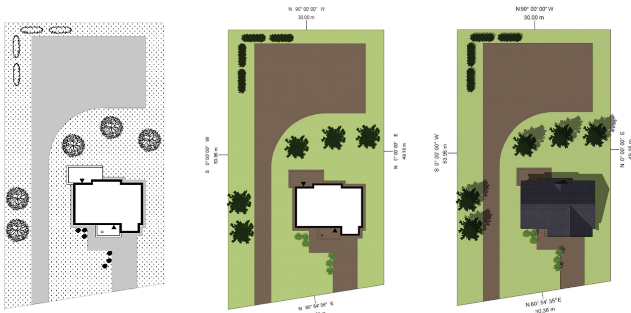
Rys. 3. Różnice w stylu wyświetlania rzutu zagospodarowania działki (od lewej) w technologii CAD, BIM oraz BIM z włączonymi efektami wizualnymi m.in. cieni i oświetlenie naturalne
