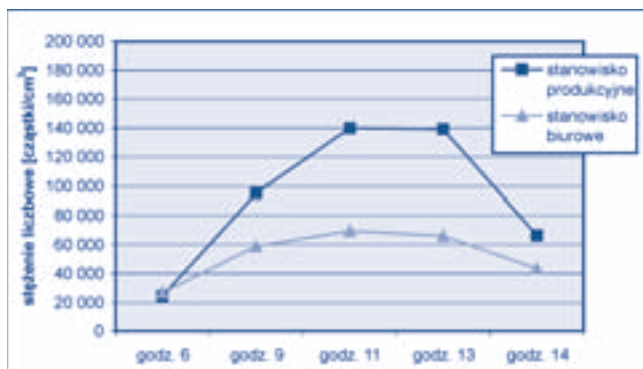
Rys. 5. Wyniki pomiarów liczbowego stężenia cząstek pyłu o wymiarach z zakresu 0,02-1 \mu\text{m} z użyciem przyrządu P-TRAK Ultrafine Particle Counter model 8525, przeprowadzonych na stanowiskach pracy w pomieszczeniu produkcyjnym i w pomieszczeniu biurowym
