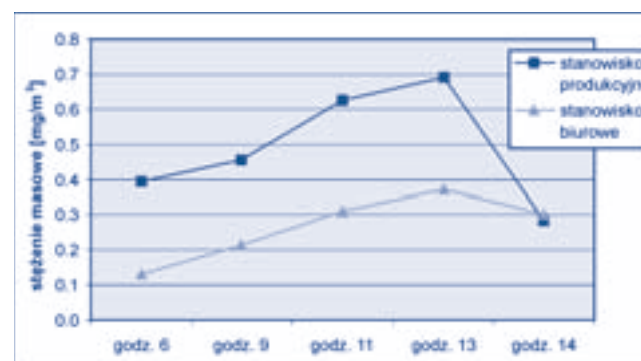
Rys. 3. Wyniki pomiarów masowego stężenia pyłu o wymiarach cząstek z zakresu 0,1-10 \mu\text{m} z użyciem przyrządu DUST TRAK Aerosol Monitor model 8520, przeprowadzonych na stanowiskach pracy w pomieszczeniu produkcyjnym i w pomieszczeniu biurowym
