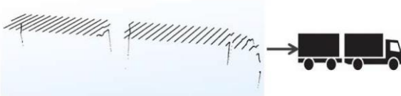
Rys. 8. Wykrycie konturów pojazdu przez jednostkę analizującą poprzez porównanie z wartościami odniesienia w celu odróżnienia rodzaju pojazdu [8]
