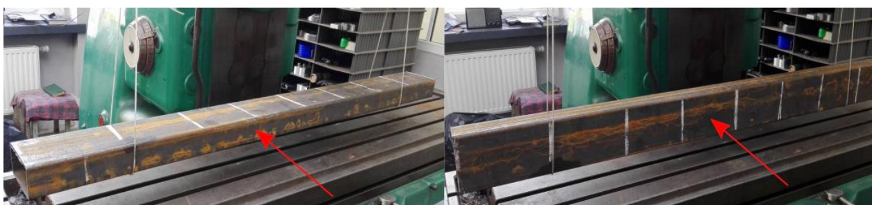
Rys. 3. Swobodne zawieszenie belki, które umownie nazwano jako „poziome” (rysunek po lewej) oraz „pionowe” (rysunek po prawej), strzałka wskazuje kierunek wymuszenia Fig. 3. Two methods of free suspensions of the beams, the arrow indicates the direction of forced vibration
