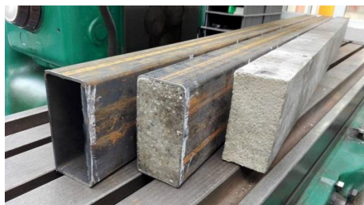
Rys. 2. Badane profile – profil stalowy, profil stalowy wypełniony polimerobetonem oraz odlew z polimerobetonu Fig. 2. Steel profile, steel profile filled up with polymer concrete and polymer concrete cast
