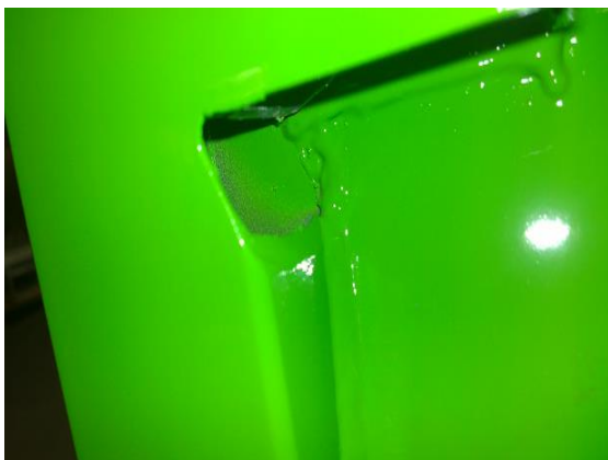
Rys. 2 Miejsce niezgodne z PN-EN ISO 12944-3. W tym miejscu podczas pracy naczepy będzie zbierała się woda powodując przedwczesną degradację zabezpieczenia antykorozyjnego []
