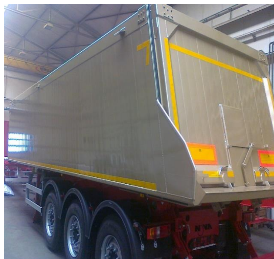
Rys.3. System epoksydowo-poliuretanowy (Temacoat GF Primer/Temadur 90) pozwala na pomalowanie muldy nawet na złoty kolor [opracowanie własne]
