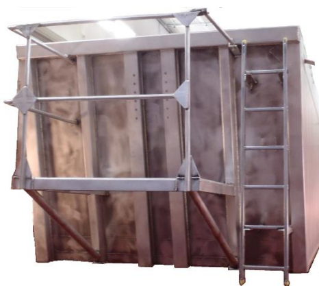
Rys. 1. Przygotowane podłoże skrzyni naczepy dla właściwego zabezpieczenia antykorozyjnego [opracowanie własne]
