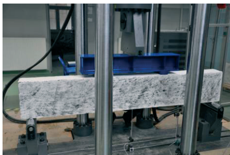
Rys. 2. Ustawienie belki B1 z powierzchnią przygotowaną do pomiaru stanu deformacji
