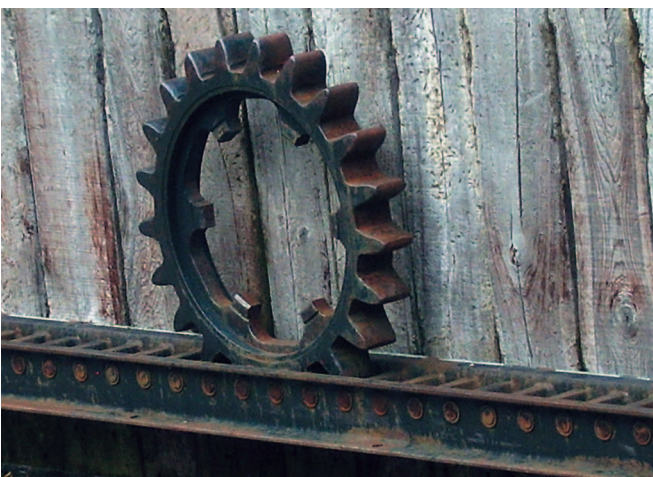
Koło zębate i zębatka systemu Riggenbacha, Stansstad–Engelberg-Bahn, Szwajcaria (28.10.2010 r.) Fot. Hans Hug
