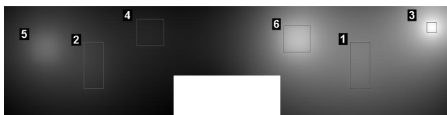
Rys. 4. Wynik optymalizacji rozmieszczenia na płytce PCB - rozkład temperatur Fig. 4. The optimization result – temperature distribution
