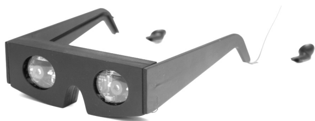
Rys. 2. Prototyp elektronicznych okularów do dźwiękowego „obrazowania” otoczenia Fig. 2. Environmental sound imaging glasses prototype
