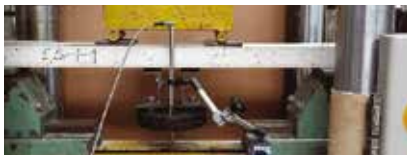
Rysunek 3. Przykładowe sposoby realizacji obciążenia podwieszono do rozciąganej okładziny elementu warstwowego za pomocą nitów BulbTite typ RV 6604-6-4W: a) 0,05 kN / rdzeń styropianowy, b) 0,20 kN / rdzeń z wełny mineralnej, c) 0,30 kN / rdzeń z pianki poliuretanowej
