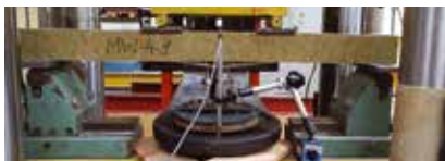
Rysunek 6. Odsłonięcie dolnej okładziny od rdzenia z wełny mineralnej przy obciążeniu
