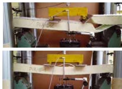
Rysunek 5. Mechanizmy zniszczenia elementów warstwowych z rdzeniem z pianki PIR: a) ścięcie rdzenia, b) wyboczenie okładziny ściskanej
